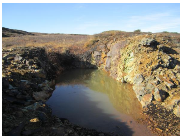
Dagbruddet til hovedskjerpet er ca 7 m x 2 m og ca 2,5 m dyp lengst inne iflg. Terje Bjerkgård, NGU. Han hadde en befaring til gruva 23. oktober 2001. Malmdatabasen har referanse 1640-057.
